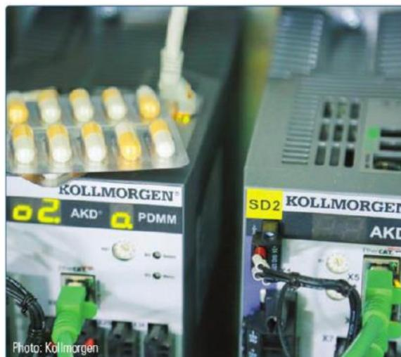
*L'AKD PDMM porta PLC e Motion Control di elevate prestazioni in macchine tecnologicamente avanzate.*
